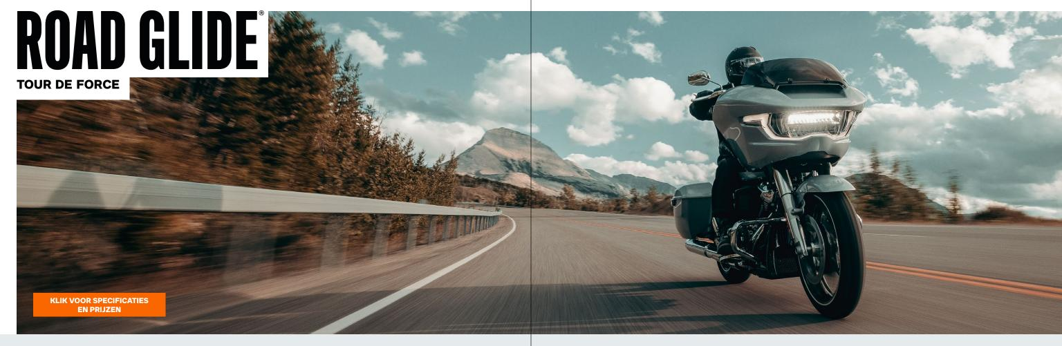
De Road Glide heeft een aerodynamische Sharknose-kuip en een vloeistofgekoelde Milwaukee-Eight® 117-motor die 176 Nm koppel produceert, terwijl het verminderde gewicht het rijgedrag responsiever maakt. Met aanpasbare rijmodi, Bluetoothconnectiviteit en een 12,3-inch touchscreen-display biedt de Road Glide een verfijnde mix van technologie, stijl en vermogen.
